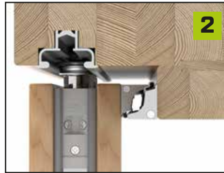
FLÄCHENBÜNDIGE FÜHRUNGSSCHIENE MIT ROLLENFÜHRUNG für einzigartig leichtgängigen Schiebe- komfort
