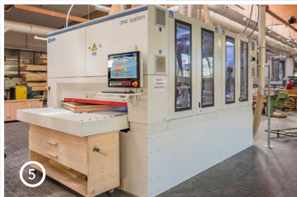
Oberflächenbearbeitung mit hochmodernem Schleifzentrum
