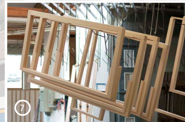
Oberflächenbehandlung mit Lack auf Wasserbasis
