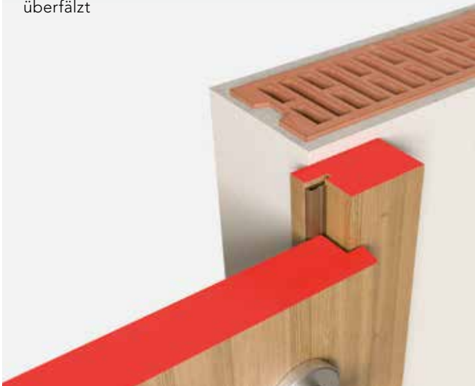
Pfostenstock Typ Vinschgau, (mit Schattenfuge) überfälzt
