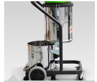
Bequemes Ausleeren des Behälters ohne Abnehmen des Saugerkopfes und ohne Kontakt mit den schmutzigen Filtern dank ausklinkbarem Behälter
