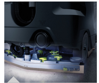
Die Teile, die am Ende der Arbeitsschicht regelmäßig gereinigt werden müssen, sind gelb gekennzeichnet, um Zeit zu sparen und die Scheuersaugmaschine stets in optimalem Zustand zu erhalten
