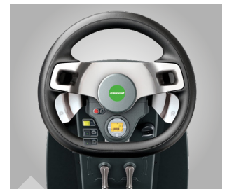
Lenkrad in der Ausführung BASIC mit kleiner Anzeige und Schaltwippen für Arbeitsdruck und Rückwärtsgang
