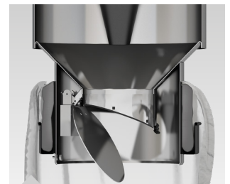
dryCAT 320 BAG-H Pro: ▶ Verschlussklappe schließt automatisch, solange der Sauger außer Betrieb ist. So wird ein Nachrutschen von Staub beim Entsorgen des Sammelbeutels verhindert
