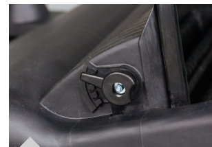
Einfache und werkzeug- lose Höhenverstellung der Kehrwalze
