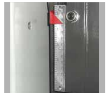
Eingestellte Höhe des Arbeitstisches zusätzlich über Skala ablesbar
