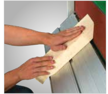
Gehrungen bis 45° durch Schwenken des Längstisches
