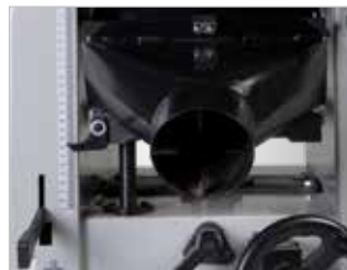
Dickentischverstellung über Handrad, Skala und numerischer Anzeige
