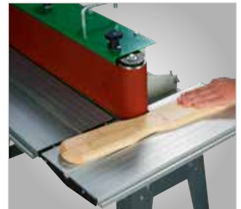
Einfachstes Schleifen von Radien
