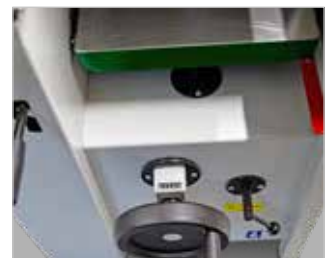
Dickentisch Führung auf mittlerer Säule und Zusatzführung Höhenverstellung über Handrad Höhenanzeige durch mecha- nisches Zählwerk mit Genauigkeit 0,1 mm
