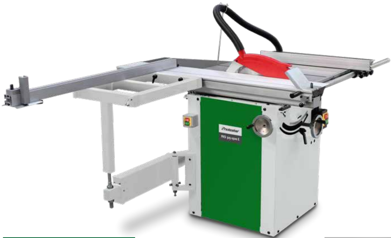
Handrad für Höhenverstellung des Sägeblatts
