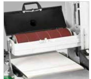
Einfacher und schneller Schleifbandwechsel
