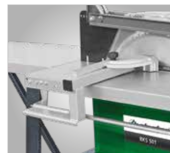
Querschneidvorrichtung Winkelverstellbar Mit Keilschneidlehre Führung auf Rundstange über wartungsfreie Gleitlager
