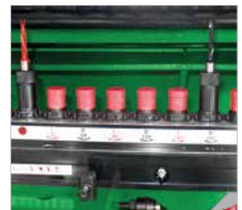
21 Bohrspindeln Sechs Schnellwechsel-Bohrfutter für Schaft 10mm im Lieferumfang
