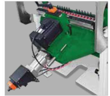
Bohraggregat Pneumatisch auf 45 und 90 Grad schwenkbar
