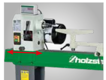
Der Spindelkasten kann zusätzlich seitlich verschoben und an jeder Stelle des Drehselbettes arretiert werden
