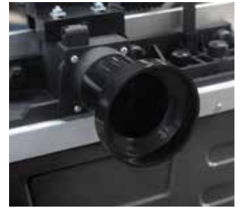
100 mm Anschlussstutzen für externe Absaugung
