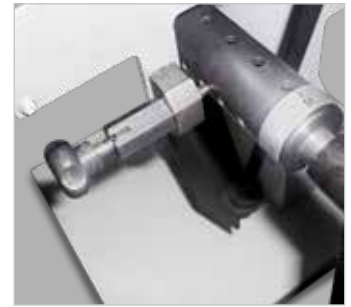
Reihenbohrungen durch Dübelbohrereinrichtung mit Rasterteilung 16/22/25/32 mm möglich
