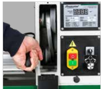
Werkzeugloses Wechseln der Übersetzungsstufe durch leichtes Ummontieren des Keilriemens
