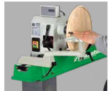
Für Drehselarbeiten an Werkstücken im Querholzbetrieb, die größer als das Stichmaß der Bank sind, kann der Spindelstock geschwenkt werden. Die Bettverlängerung in Verbindung mit der umsteckbaren Handstahlaufgabe ermöglichen maximale Flexibilität.
