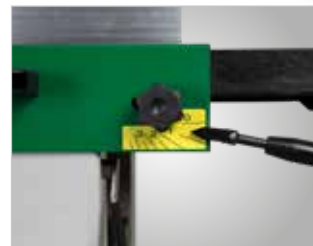
Verstellung der Spanabnahme über Bedienhebel
