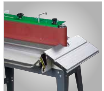
Mit Quertisch zum Konturschleifen, schwenkbar bis 45°
