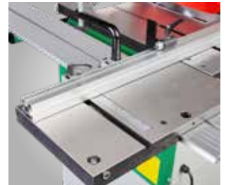
Schiebetisch mit integrierter Skala
