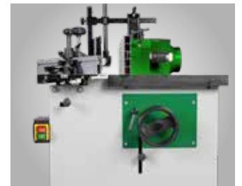
Handrad für Höhenverstellung. Sicherheitsvorrichtungen im Lieferumfang
