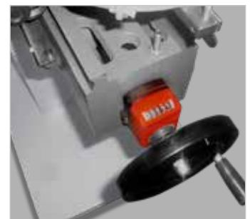
Bequeme, exakte Tischhöhenverstellung über ein Handrad mit numerischer Anzeige
