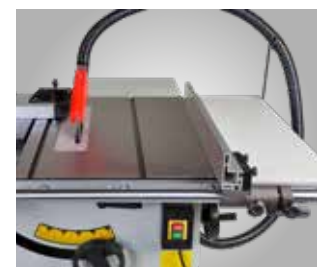
Parallelanschlag mit Rundstangenführung
