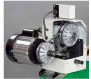
Vario Drehzahlregulierung von 500–2.000 min -1 über Keilriemen und verstellbare Konusscheiben
