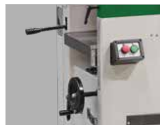
Dickenhobeln Höheneinstellung des Dickentisch einfach und bequem über Handrad und Skala Spanabnahme bis zu 5 mm möglich
