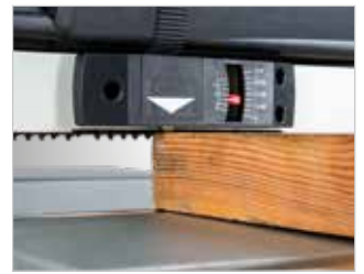
Mechanische Anzeige der Spanabnahme
