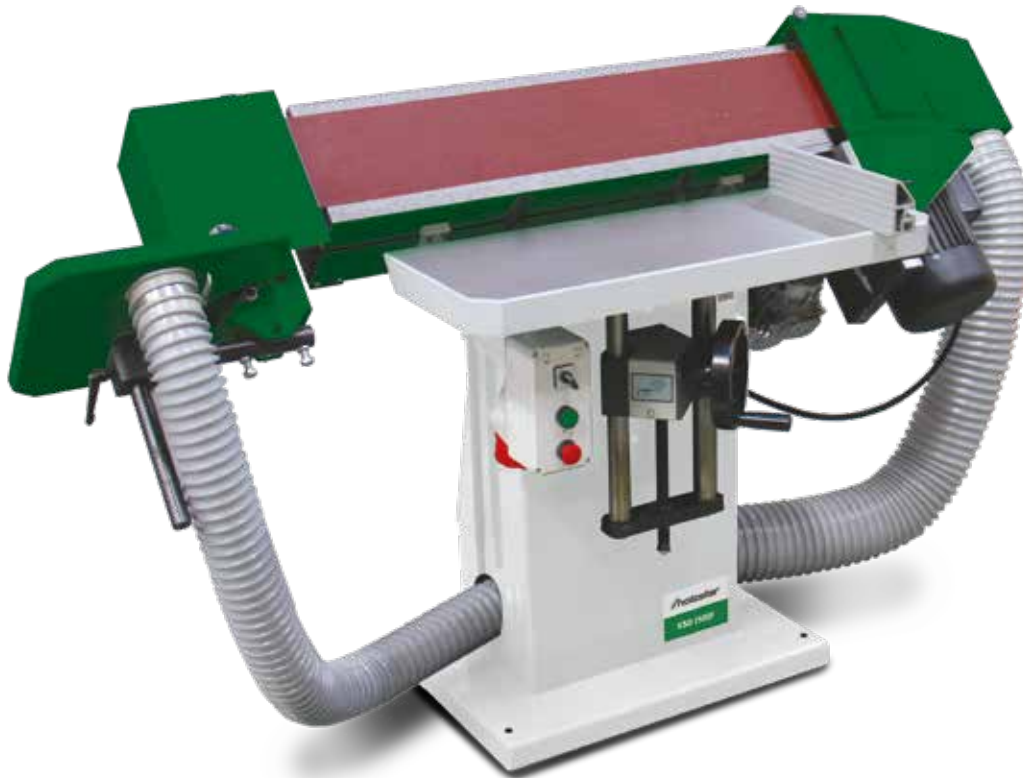
Höhenverstellbarer Zusatztisch mit Absaugung, zum Schleifen von Innenradien
