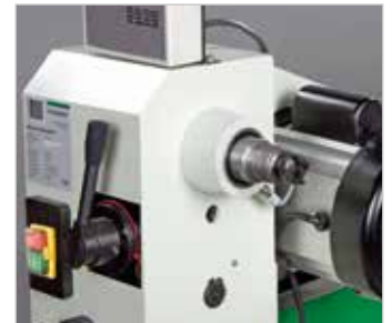
Über einen Hebel an der Bedienseite ist die gewünschte Drehzahl schnell und bequem einstellbar
