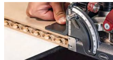
Zeta P2 mittels Positionierclip in Bohrung ausrichten und nächste Nut fräsen*
