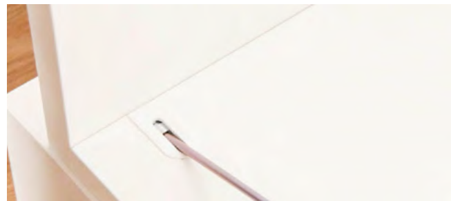
Möbelelemente mit Akkuschrauber und Cabineo-Werkzeug verbinden. Einfaches, schnelles Arbeiten mit voreingestelltem Drehmoment ca. 2.5 Nm.
