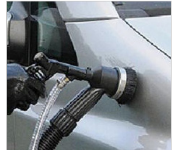
• Strahlmittel wird nach dem Auftreffen auf die Oberfläche sofort wieder abgesaugt und zurückgeführt
