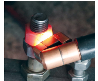
› Erwärmen einer Mutter mit der Fokusspule schräg
