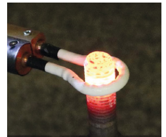
› Erwärmen eines Gewindebolzens mit der wassergekühlten Spule
